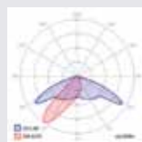
Linssi V14 - soveltuu normaaleille teille - epäsymmetrinen linssi tuottaa tasaisen valon tielle
